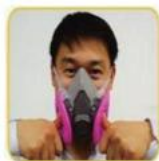
图 1-4（c）负压密闭性检测
