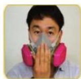
图 1-4（b）正压密闭性检测
