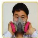
图 1-4（c）负压密闭性检测
