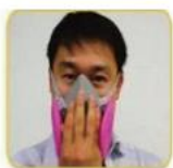
图 1-4（b）正压密闭性检测
